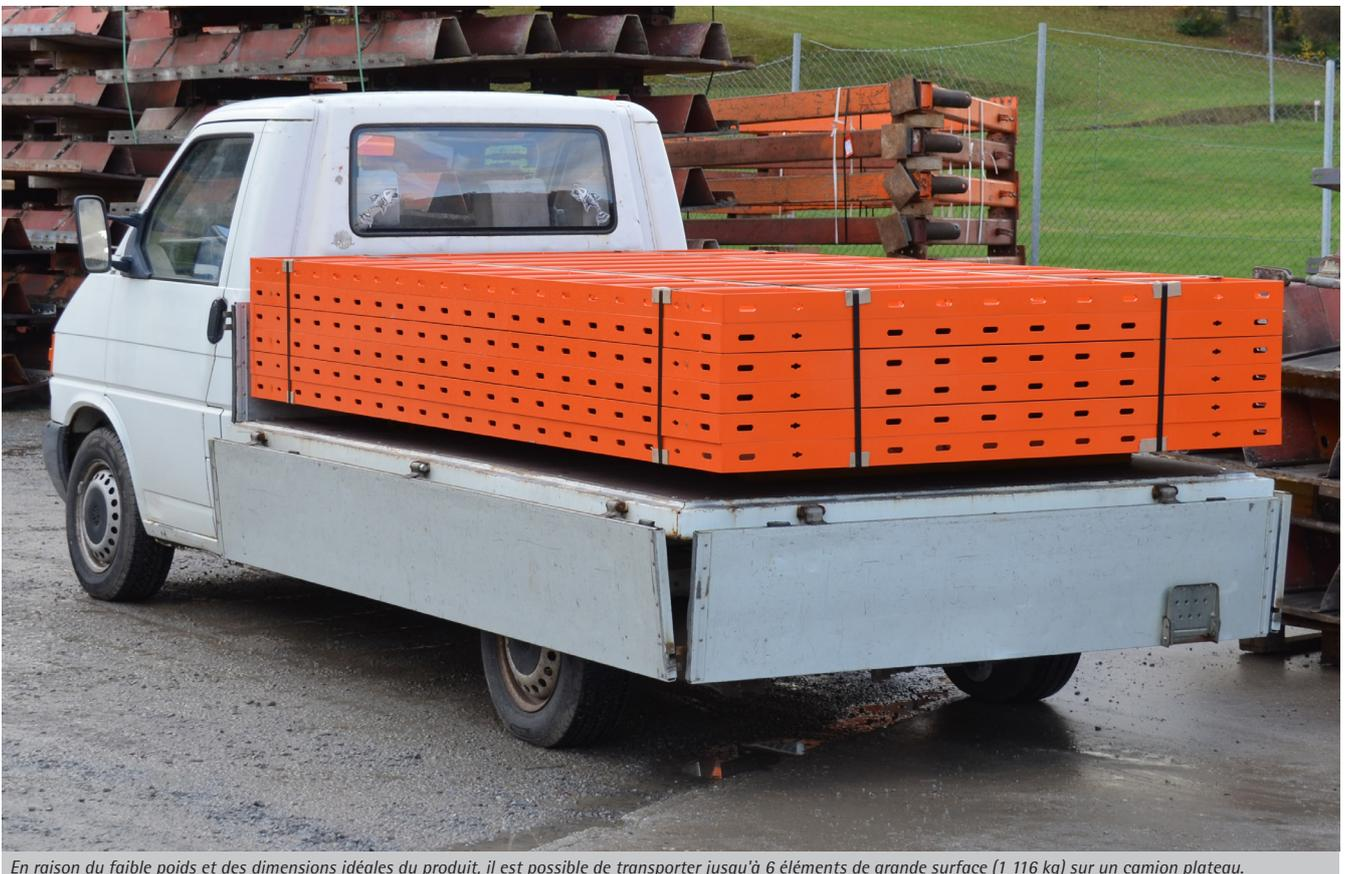
En raison du faible poids et des dimensions idéales du produit, il est possible de transporter jusqu'à 6 éléments de grande surface (1 116 kg) sur un camion plateau.
